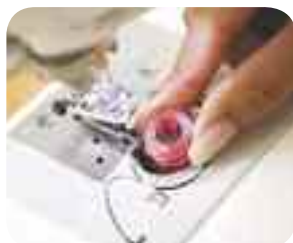
Plaats de spoel, trek de draad in de richting van de pijl en begin met naaien.
